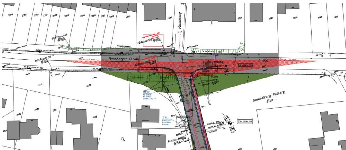
**Abb.6 Anbindung L288 mit Eintragung der Anfahrsicht von 70 m bei 50 km/h o. M.**
